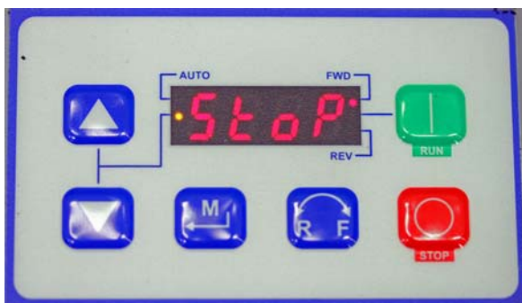
Figure 15 Панель управления частотно-регулируемого привода (ЧРП)
