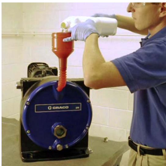
Figure 4 Заполнение насоса смазочным маслом для шланга
